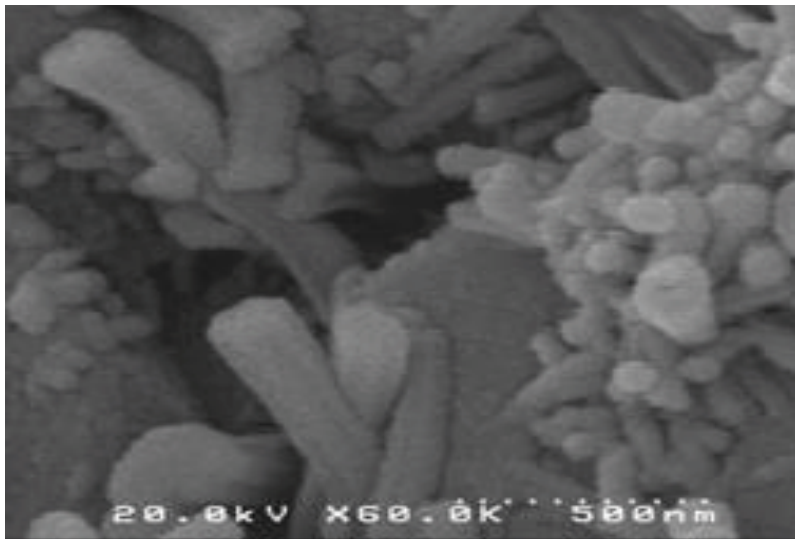
شکل ۷: تشکیل نانواستایرن‌های کشیده‌شده در وجوه ترک
