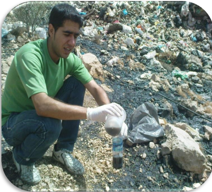
شکل ۲۶: بررسی غلظت آمونیاک در تحقیقات میدانی (نمونه برداری از شیرابه تازه)
