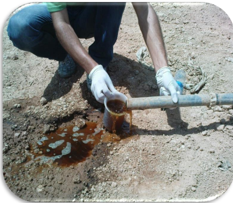
شکل ۲۹: نمونه برداری از شیرابه خروجی چاهک شیرابه
