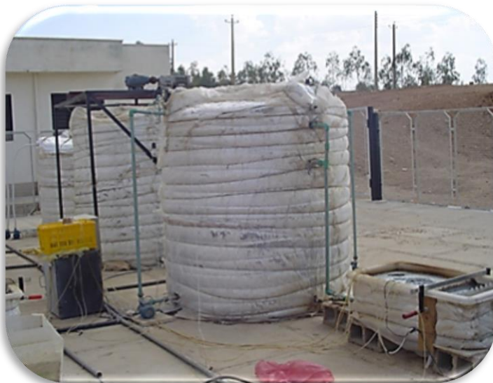
شکل ۲: تصویر اجرای سیستم ترکیبی هاضم بی‌هوازی با آهنگ بالا و لجن فعال
