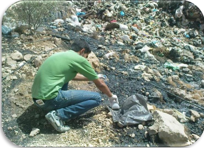
شکل ۲۵: بررسی غلظت آمونیاک در تحقیقات میدانی (نمونه برداری از شیرابه تازه)
