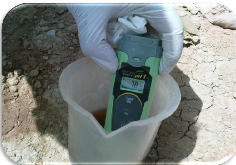
شکل ۳۰: اندازه گیری PH شیرابه خروجی از چاهک شیرابه
