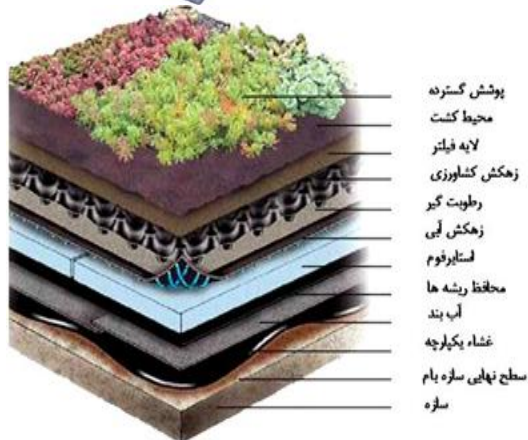
شکل ۷: لایه‌های تشکیل‌دهنده‌ی پشت‌بام سبز
